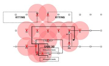
Cette solution permet de localiser le car-à-fourches dans l'entrepôt et d'historiser ses déplacements. Les tags permettent de connaître le point de départ et le point d'arrivée de l'équipement logistique et ainsi de calculer le temps de déplacement de ce dernier. Cela permet d'optimiser et d'automatiser les inventaires.
