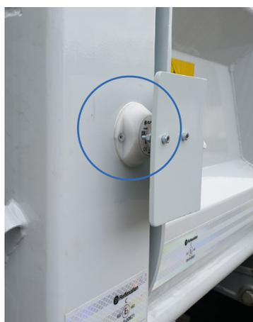
Le capteur magnétique sans fil est installé sur la benne et l'aimant sur la ridelle. Lorsque l'aimant et le capteur magnétique sont séparés de plus de 2 cm, **une alerte est envoyée au chauffeur** pour ainsi réduire l'accidentologie des véhicules à ridelles. L'information de perte de contact magnétique est envoyée en Bluetooth Low Energy au boîtier ATLAS Connect qui va lui-même jouer le rôle de passerelle et faire remonter l'information sur l'application mobile ou PC.
